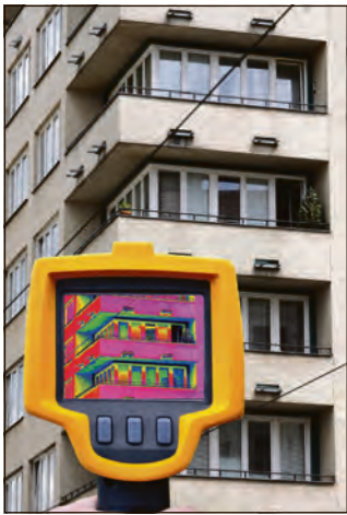
Mit Thermografie lassen sich Wärmebrücken und Lecks sichtbar machen – so können Eigentümer Energie sparen und Gebäudeschäden vermeiden.
