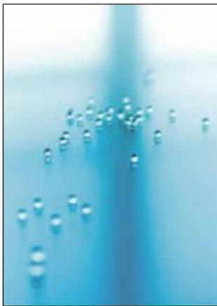
Mikroskopisch kleine Glashohlkugeln, sogenannte Glass Bubbles, machen gut die Hälfte des innovativen Dämmsystems aus. Foto: dj-d-k/3M/Ansgar Pudenz
